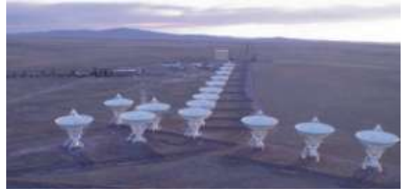
図 10 米国にある電波干渉計 VLA。25m のアンテナ 27 台で1 台の電波干渉計を構成している。米国立電波天文台の web ページ ( http://www.nrao.edu ) より。
